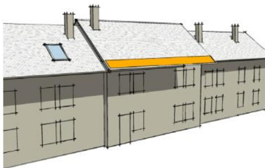
Aligné en bas de toiture
